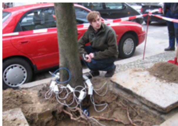
Mittels Schalltomographie wird Wurzelfäule im Inneren des Baumstammes lokalisiert. Dies läßt Aussagen über die Standsicherheit des Baumes zu.
